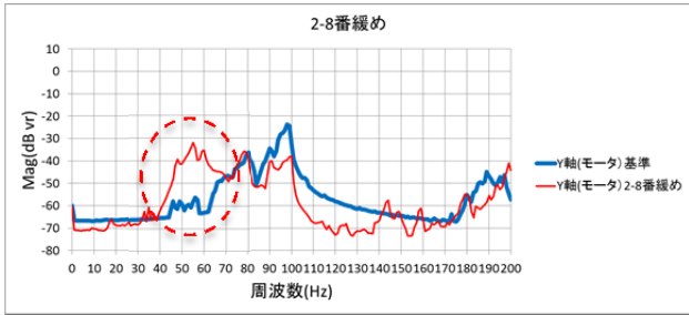
同じ取付け金具側 2 本のボルトが緩んだ場合
