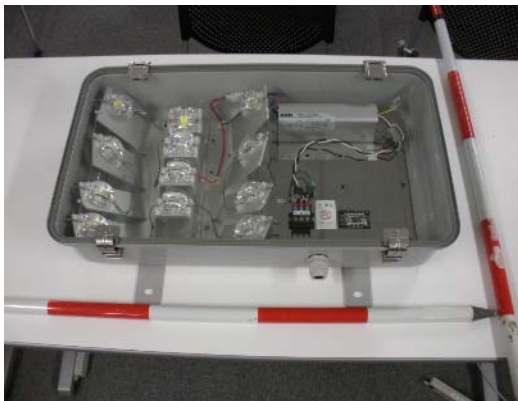
写真-1 標準的なトンネル照明器具（LED基本照明用）
