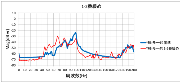
同じ側 2 本のボルトが緩んだ場合
