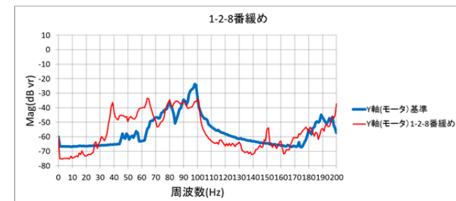
図-18 起振機加振による取付けボルト緩み影響 (3本緩み) 青：4点取付けボルト固定時出力 赤：各条件時におけるピックアップ出力
